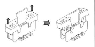
・ スライダーをロックした状態で、FPC/FFC を引き抜か ないで下さい。引き抜く際は必ずロックを解除した状態で 行って下さい。
