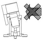
③ FPC/FFC を図の向きで挿入します。 奥まで確実に挿入して下さい。
