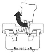
・FPC/FFCの挿抜に関して、FPC/FFCの種類によっては、下記切かき部(丸枠)の剥がれ等が発生する場合があります。 剥がれ等が発生した場合、接触不良になる可能性がありますので、事前にご確認の上、使用するFFC/FPCの選定をお願い致します。
