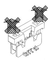
② スライダーを図の様に傾けます。 これにより FPC/FFC を挿入し易くなります。 The slider is inclined only a little as shown in figure. As a result, FPC/FFC can be made easy to insert.
